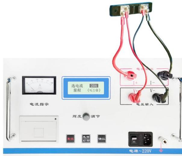
按正常测试步骤测试标准电阻的阻值，测试结果若与标准电阻上标明的阻值相符（误差在 0.2% 之内），说明仪器状态正常，可以继续使用。
