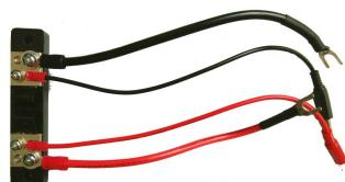
将标准电阻接至仪器的接线柱上，如下图：
