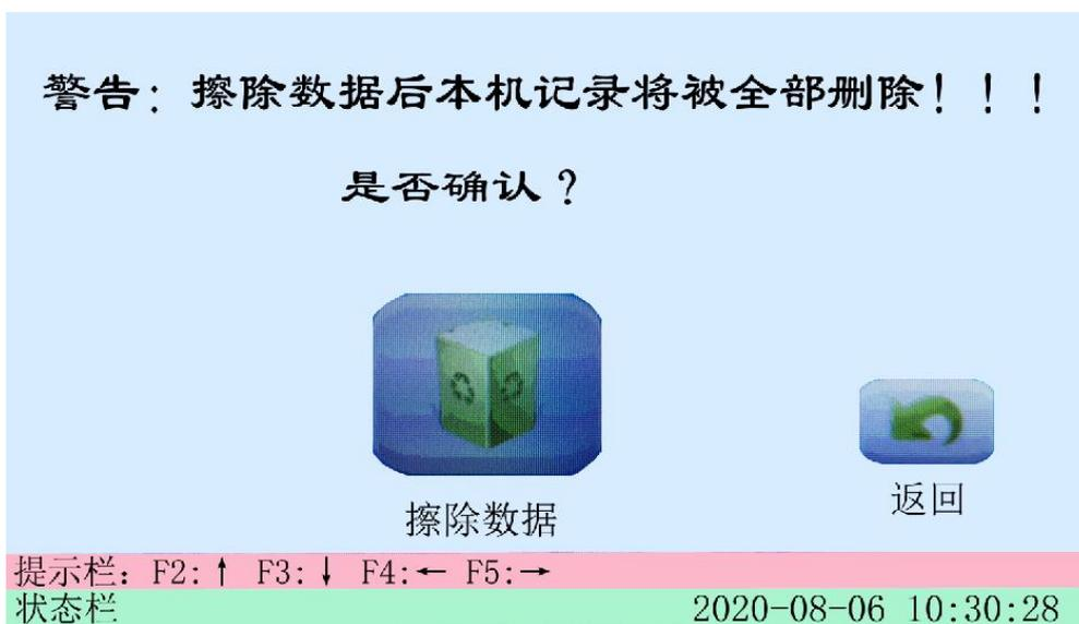
触摸“擦除数据”图标，或选中【擦除数据】图标后按【确认】键，清除仪器全部已存测试数据。
