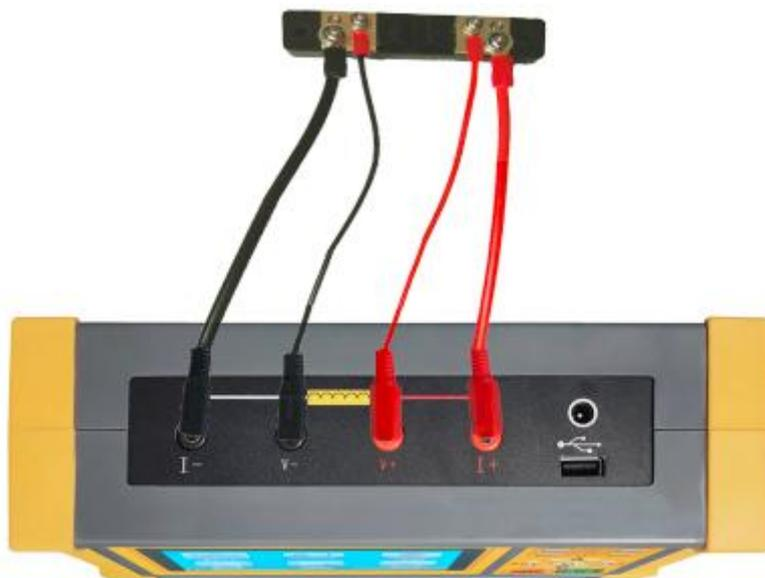
按照正常测试步骤测试标准电阻的阻值，测试结果若与标准电阻上标明的阻值
