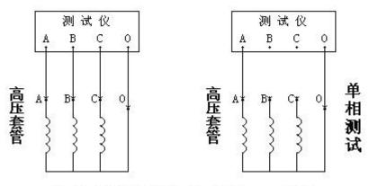
变压器绕组连接方式 - Y型
