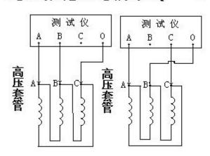
Y 型接线 要分别测试 A B、BC 、CA 的时候请用单相测试 ②. 确认以上接线无误后,开机,仪器自检后进入主菜单
