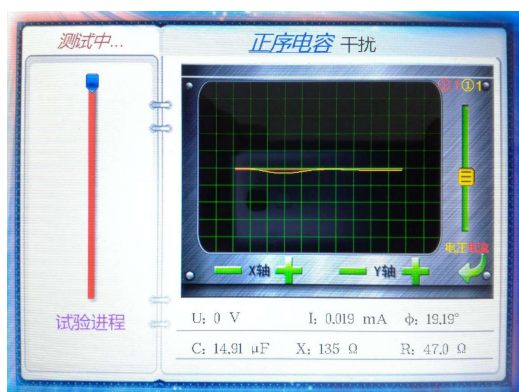
图 7-5 先测干扰电压
