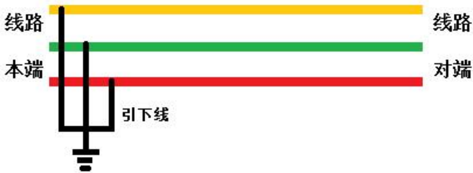
图 6-3 将被测线路本端引下线接地
