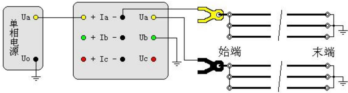
图二十八 互感阻抗测试接线图
