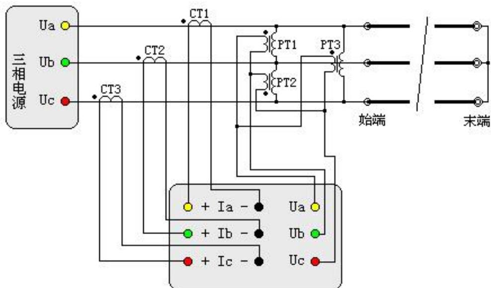
图十六 正序阻抗测试接线（经 PTCT）
