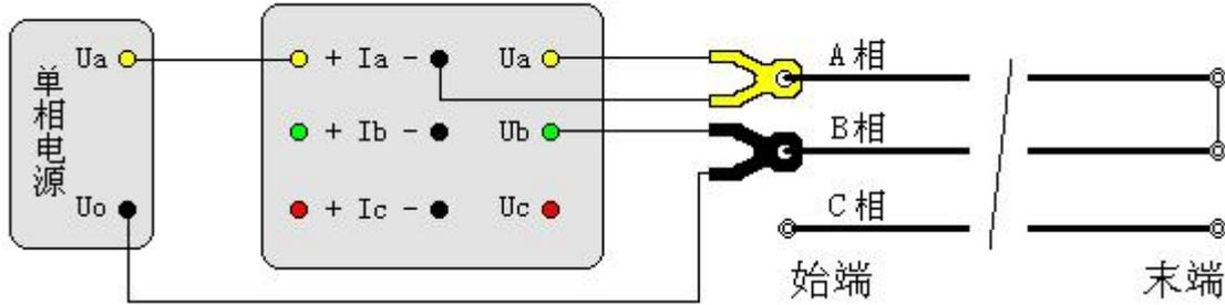
图二十二 相间阻抗测试接线图
