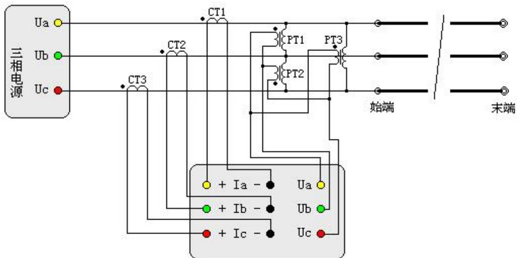
图十八 正序电容测试接线图（经 PTCT）
