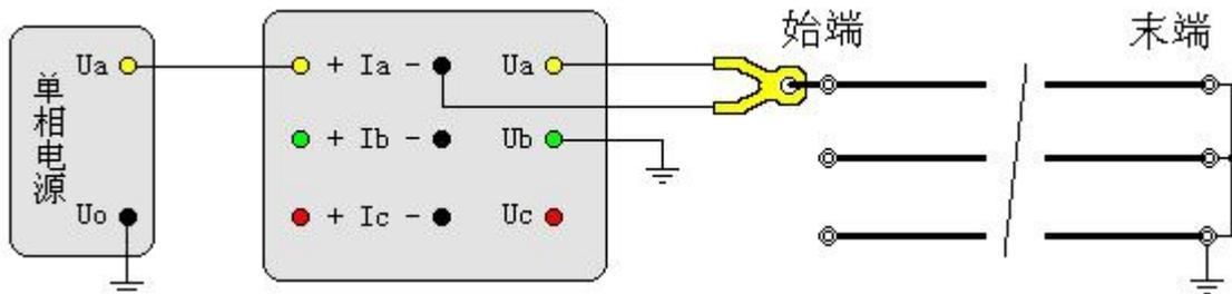
图二十五 线地阻抗测试接线图
