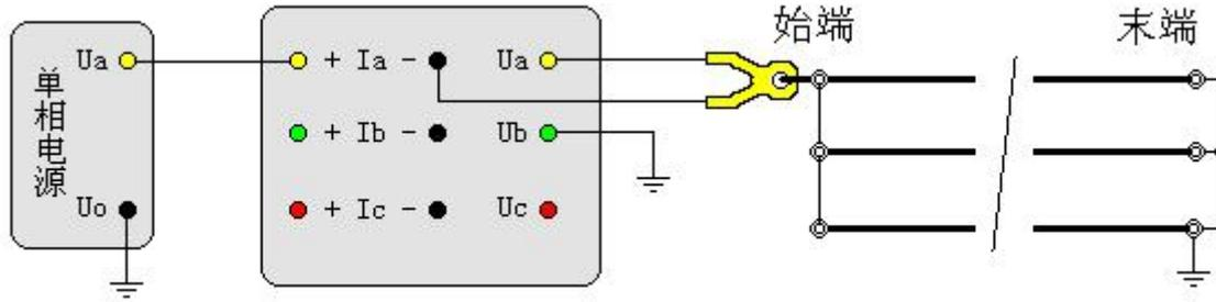
图十九 零序阻抗测试接线图
