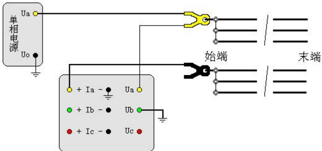
图二十九 耦合电容测试接线图
