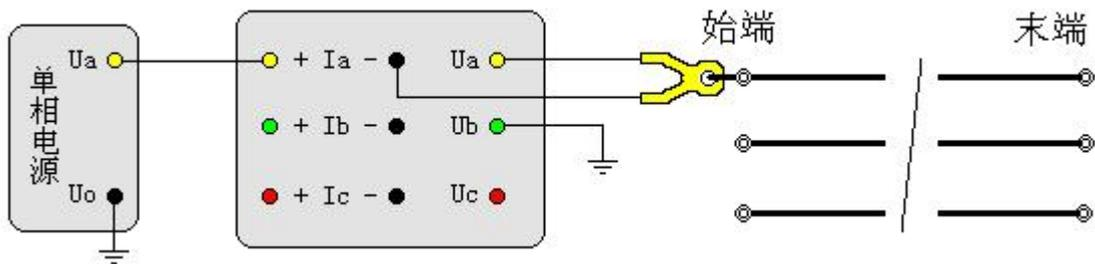
图二十六 线地电容测试接线图
