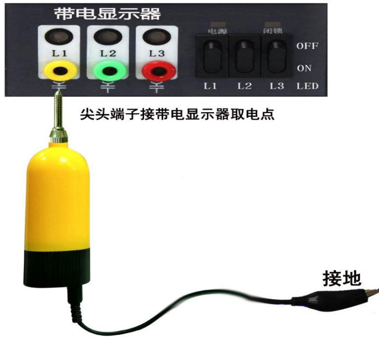
带电显示器核相示意图（图3）
