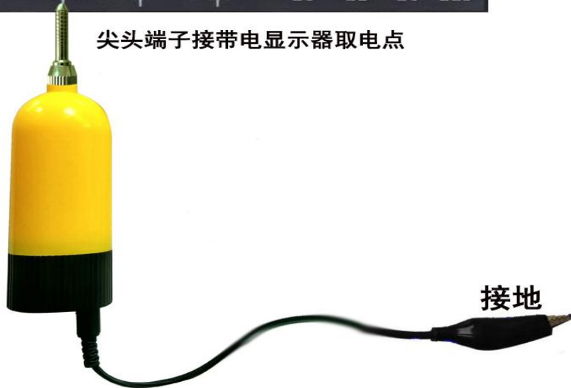
带电显示器核相示意图（图3）
