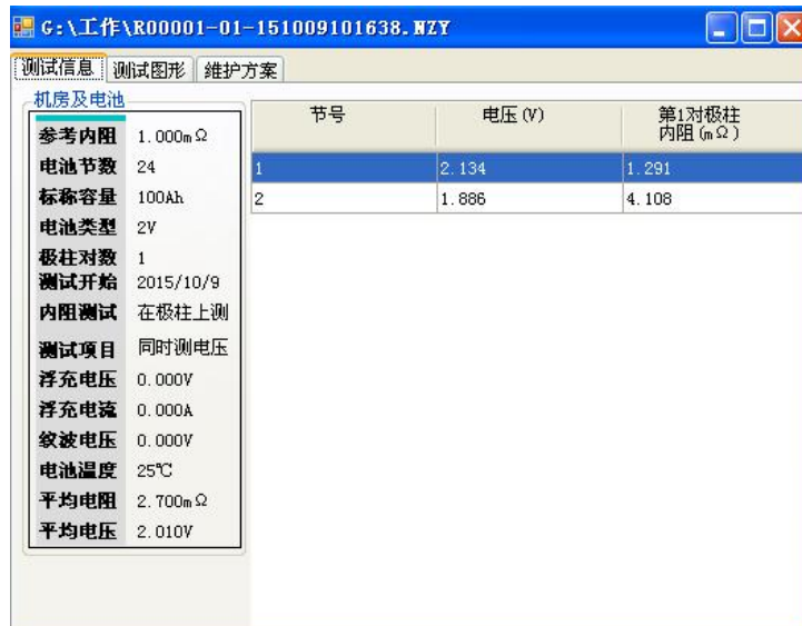
图 5.4 电池组设置参数及测试数据
