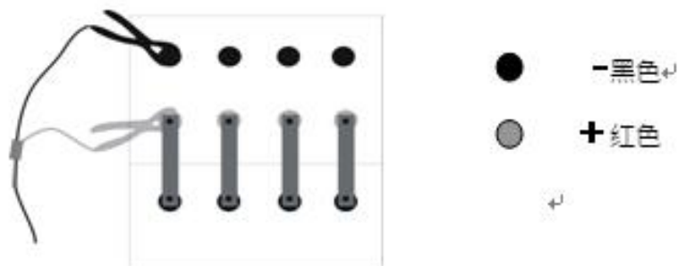
图 3.2.3 极柱测量连接方式
