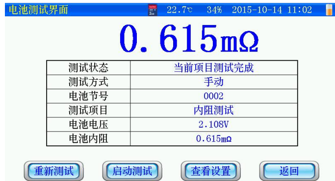
图 4.3.1 在极柱上同时测量电压和内阻测试界面
