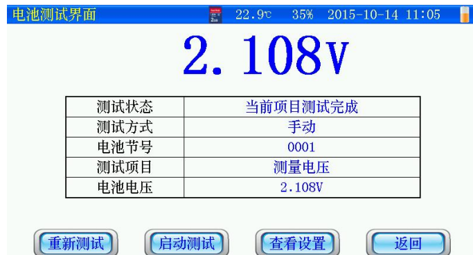
图 4.3.1 在极柱上同时测量电压和内阻测试界面
