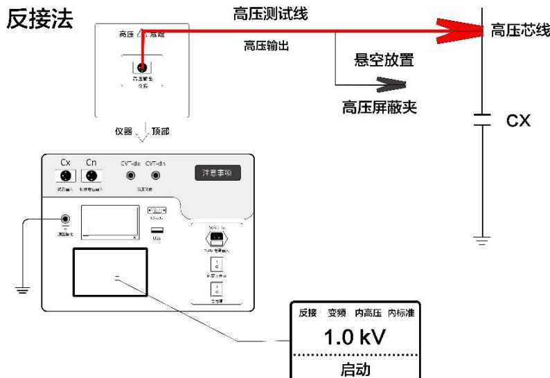
用高压线芯线（红夹子）连接试品高压端。
