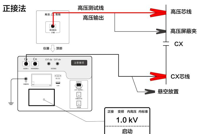
正接线施加内高压时，高压线的芯线（红夹子）和屏蔽（黑夹子）最好都要接试品高压端。如果只用芯线加压，芯线电阻较大，可能引起附加介损。
