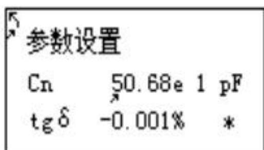
移动光标，“增大”和“减小”键，修改光标处内容。设置完毕按住“启停”键不放，直到返回测量菜单，同时参数被储存，数据有效。右下角显示“\*”表示不允许修改其它数据，这些数据为仪器出厂参数，一旦变更会严重影响测量！
