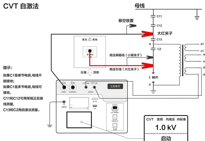
高压芯线接  $C_{12}$  末端 J, CX 芯线接  $C_{12}$  上端。不要 CX 接  $C_2$ 、高压线接  $C_{12}$ ，这样做的数据误差较大。
