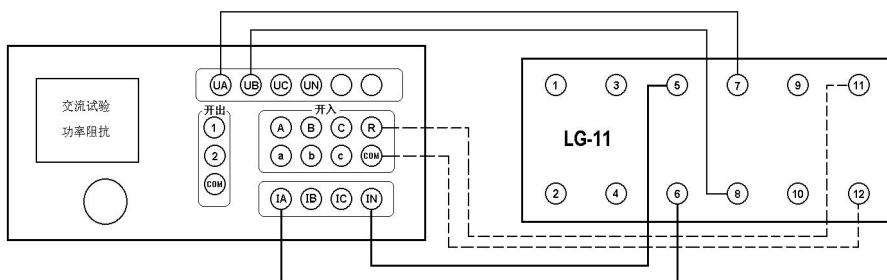
设置  $U_{ab}$ （或  $I_a$ ）的步长，增加电压（或电流）。测出最小动作功率。如上图所示。
