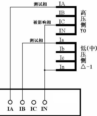
Y 侧相位调整，无零序修正，按单相短路接线
