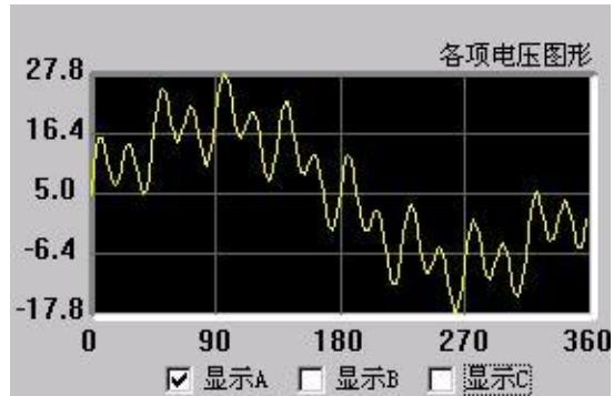
在同一个通道中叠加的波形有效值总和不能超过 120V (40A/30A)。若超出范围，软件将给出超出范围提示，此时请检查输入数值或检查数据变化后总幅值是否已经超过了 120V (40A/30A)。在数据输入时和输出变化中均要进行叠加幅值检查。
