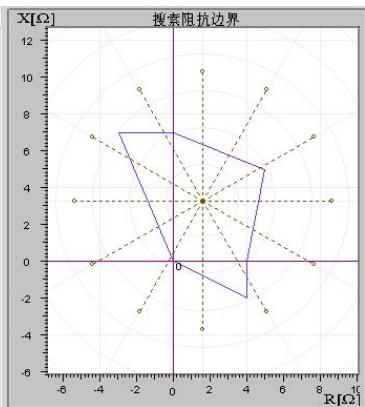
都可以设置为负数。各角点添加完后点击“画图”按钮，至此软件即绘出了理论的阻抗边界曲线以及相应的误差曲线（以虚线表示）。此时可用鼠标移至图形的中心位置点击鼠标左键，以设置扫描中心点，如右图所示。
