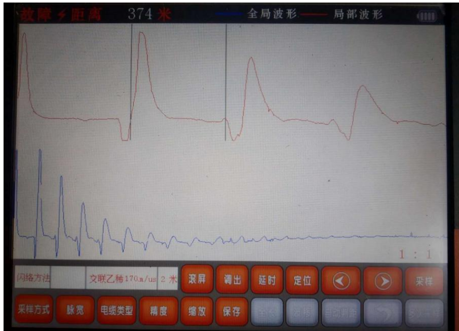
冲击闪络法测试波形示例
