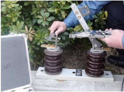
第一步 测量触头的宽度 a
