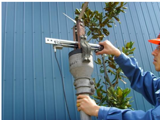
第三步 测量触指压力
