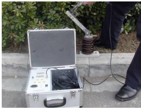
第三步 测量触指压力
