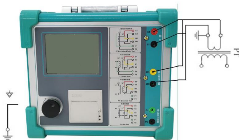
图 2.7 PT 直阻、励磁试验接线方式
