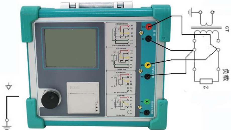
图 2.2 CT 二次负荷试验接线方式
