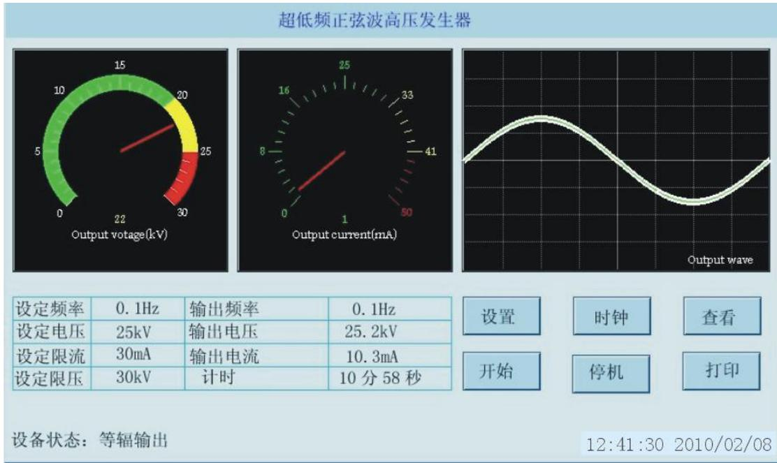
图 8 控制器提示等幅输出
