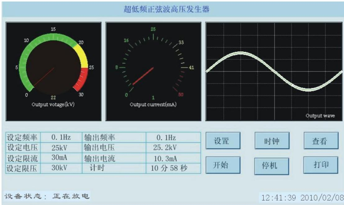
图 10 控制器提示正在放电
