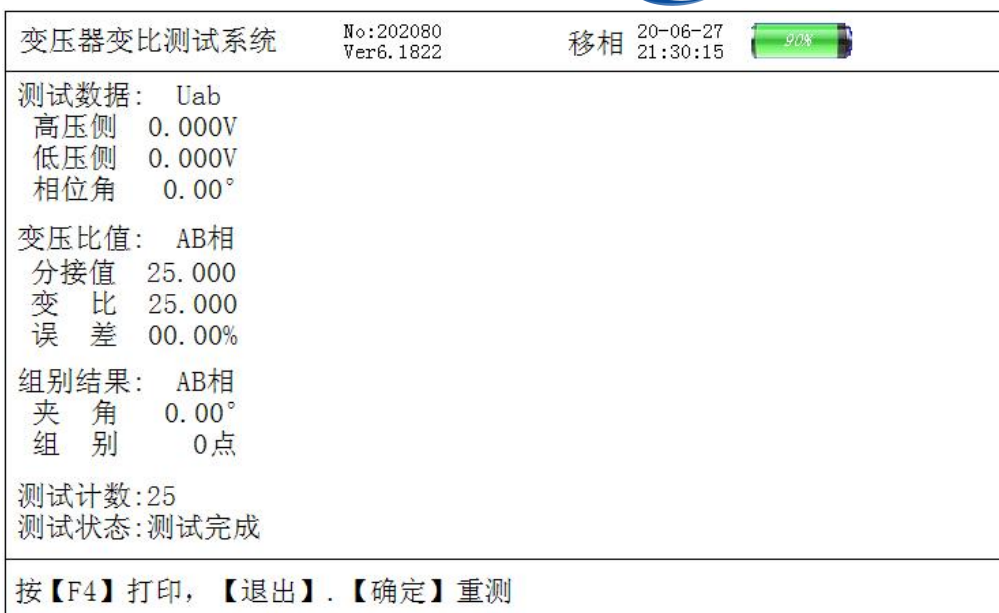
图十、单相变压器测试接线结果屏
