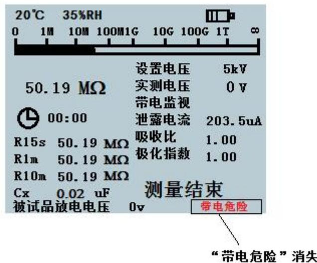
图 3-6（测量结束正在放电）
